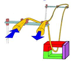
Machen wir im obigen Versuch den Hufeisenmagneten zu (Magnetische Brücke oder Joch), verschwindet im Inneren des Hufeisens das Magnetfeld fast vollständig und auf den Leiter wird trotz Strom praktisch keine Kraft mehr wirken.
