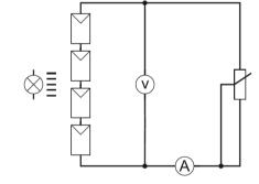
**1.** Helligkeitsregler auf Stufe **10** Den Drehknopf vom Verbraucher (Last 2) ganz nach rechts drehen (größter Widerstand). Mit dem Drehknopf den ersten Stromwert in **Tabelle 1** einstellen und den fehlenden Spannungswert eintragen.
