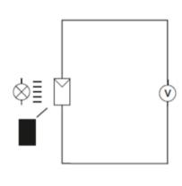
Decken Sie die Solarzelle mit dem **1/1** Abschattungsblech (vorübergehend für diese Abschattung den Regler auf **0** stellen) voll ab, messen Sie die Leerlaufspannung und tragen Sie den Wert in die Tabelle ein.
