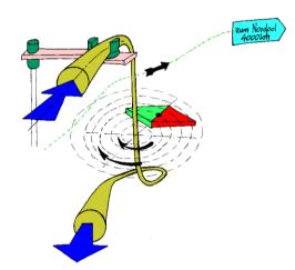
Wenn es gar keinen zweiten Leiter gibt, der erste Leiter aber durch seinen Strom an der Stelle des zweiten Leiters ein Magnetfeld aufgebaut hat, kann an der Stelle das Magnetfeld berechnet werden. Es gilt:  $k = \mu_0$
