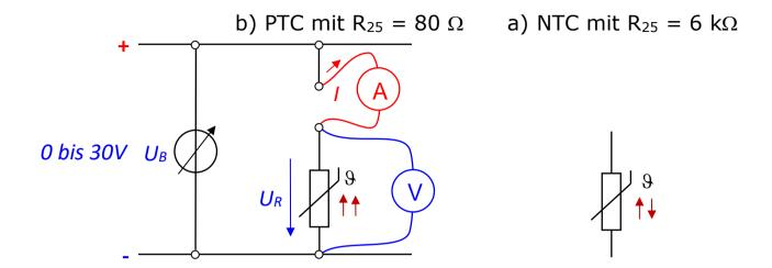
Zuerst wird der **Kaltwiderstand** von R<sub>L</sub> mit einem Ohmmeter bestimmt (siehe direkte Widerstandsmessung). Dazu muss die Spannungsquelle ausgeschaltet bleiben!
