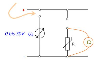
Der **Kaltwiderstand** kann auch durch die Messung einer sehr kleinen Spannung bestimmt werden. Der Strom ist so klein, dass keine Erwärmung des Widerstandes stattfindet.
