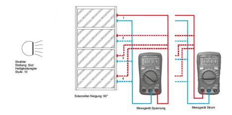
Bauen Sie das Experiment entsprechend der oben gezeigten Darstellung auf. Der Lampenarm befindet sich in Stellung **Süd**, der Helligkeitsregler auf der Stufe **10**.
