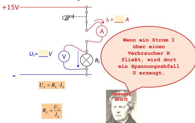
Frage 1: Wie hängt der Strom von der Spannung ab?
