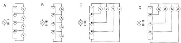
**A:** Ein Multimeter als Voltmeter nach Darstellung anschließen, der Bereichswahlschalter ist auf die Position **V (DC**) einzustellen. Bei den Solarzellen **1-4** die Leerlaufspannungen messen und in die Tabelle **1** eintragen.
