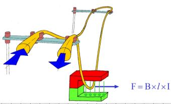
Wie stark (mit welcher Kraft F) ein stromdurchflossener Leiter in einem Magnetfeld B abgelenkt wird, hängt von der
