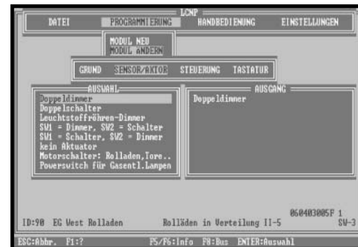
Abb. 1.6: Mit der intuitiven Menüführung von LCN-P lassen sich Sensoren und Aktoren schnell und einfach einstellen. LCN-P stellt als DOS-Programm bewusst geringe Anforderungen an den PC.
