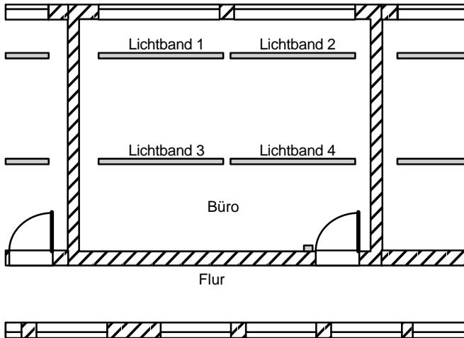
Bei der Planung von Beleuchtungsanlagen in gewerblich genutzten Räumen erfolgt die Festlegung der Art und Anzahl der Leuchten nach der gewünschten Beleuchtungsstärke. Häufig werden aus Gründen der Wirtschaftlichkeit Leuchtstofflampen eingesetzt, die in Form von Lichtbändern angeordnet werden. Die Einteilung in einzelne Schaltgruppen erfolgt entsprechend der Nutzung des Raumes.
