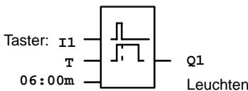
Bei einem Tastimpuls am Eingang I1 schaltet der Ausgang Q1 ein und bleibt 6 Minuten lang eingeschaltet.
