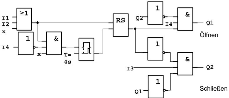
So sieht der Schaltplan aus, der dem Stromlaufplan der konventionellen Lösung entspricht.
