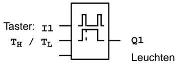
Bei einem Tastimpuls am Eingang I1 schaltet der Ausgang Q1 für eine vorbestimmte Zeit  $T_H$  ein.
