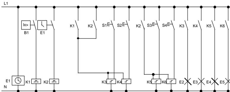
Die Leuchten werden durch Stromstoßrelais geschaltet, die durch die Taster an der Tür angesteuert werden. Unabhängig davon werden sie durch die Schaltuhr bzw. durch den Helligkeitsabhängigen Schalter über den Eingang *Zentral Aus* zurückgesetzt. Die Ausschaltbefehle müssen durch Wischrelais verkürzt werden, damit auch nach dem Ausschalten eine Bedienung vor Ort möglich bleibt.
