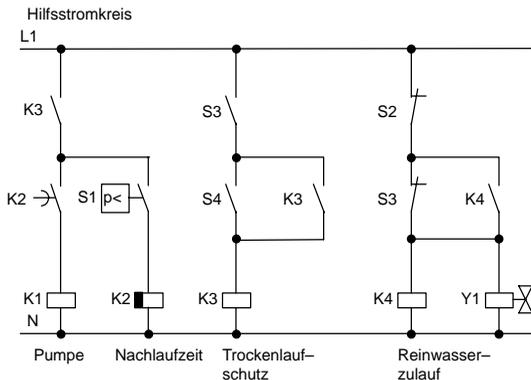
Die Steuerung der Pumpe und eines Magnetventils erfolgt über einen Druckschalter und 3 Schwimmerschalter, die im Regenwasserbehälter angebracht sind. Die Pumpe muss eingeschaltet werden, wenn der Mindestdruck im Kessel unterschritten wird. Nachdem der Betriebsdruck erreicht ist wird nach einer Nachlaufzeit von einigen Sekunden die Pumpe wieder ausgeschaltet. Die Nachlaufzeit verhindert ein andauerndes Ein- und Ausschalten während einer länger andauernden Wasserentnahme.
