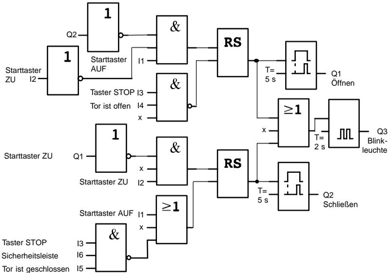
Durch die Starttaster AUF bzw. ZU wird die Fahrt des Tores eingeleitet, sofern die Gegenrichtung nicht eingeschaltet ist. Das Beenden der Fahrt geschieht durch den Taster STOP oder durch den jeweiligen Endschalter. Das Schließen des Tors wird außerdem durch die Sicherheitsleiste unterbrochen.
