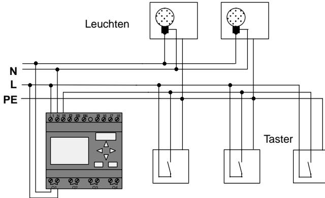
Die äußere Verdrahtung der Beleuchtungsanlage mit einer LOGO! unterscheidet sich nicht von einer konventionellen Flur- oder Treppenhausbeleuchtung. Nur der Treppenlichtautomat bzw. das Stromstoßrelais wird ausgetauscht. Zusätzliche Funktionen werden direkt in LOGO! eingegeben.
