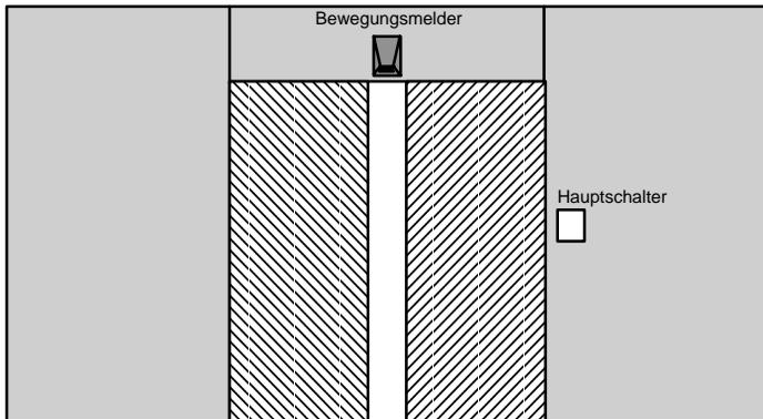
Der Antrieb der Tür erfolgt meistens durch einen Motor, der über eine Rutschkupplung die Tür antreibt. Dadurch wird vermieden, dass Personen eingeklemmt und verletzt werden. Die gesamte Steuerung wird über einen Hauptschalter an das Netz angeschlossen.
