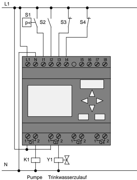
Neben LOGO! benötigen Sie zum Steuern der Pumpe nur noch den Druckschalter und die Schwimmerschalter. Zum Schalten der Pumpe müssen Sie beim Einsatz eines Drehstrommotors ein Hauptschütz verwenden. Bei Anlagen mit Wechselstrommotor müssen Sie ein Schütz vorsehen, wenn der Wechselstrommotor einen größeren Strom benötigt, als das Ausgangsrelais Q1 schalten kann. Die Leistung eines Magnetventils ist so gering, dass Sie es normalerweise direkt ansteuern können.
