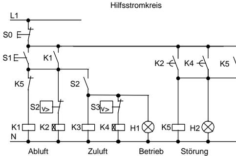
Die Ventilatoren werden mit Strömungswächtern überwacht. Wenn nach Ablauf einer kurzen Wartezeit kein Luftstrom gemessen wird, wird die Anlage abgeschaltet und eine Störung gemeldet, die durch das Betätigen des Austers quitiert werden kann.
