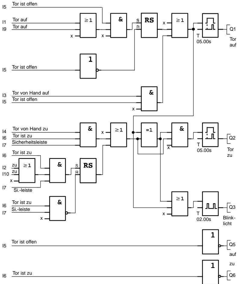
Durch die Starttaster TOR AUF bzw. TOR ZU wird die Fahrt des Tores eingeleitet, sofern die Gegenrichtung nicht eingeschaltet ist. Das Beenden der Fahrt geschieht durch den jeweiligen Endschalter. Das Schließen des Tors wird außerdem durch die Sicherheitsleiste unterbrochen.
