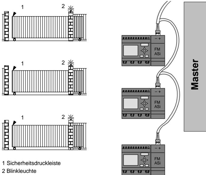
Die Zufahrt zu einem Firmengelände ist in vielen Fällen über verschiedene Stellen möglich. Nicht alle Tore können immer durch Personal vorort überwacht werden. Sie müssen deshalb von einer zentralen Warte durch den Pfortner bedienbar und überwachbar sein.
