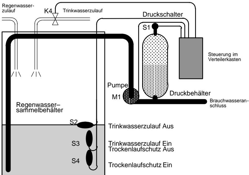
Das Regenwasser wird in einem Sammelbehälter aufgefangen. Aus dem Sammelbehälter wird es durch eine Pumpenanlage in ein dafür vorgesehenes Leitungsnetz gepumpt. Von dort kann das Regenwasser dann entnommen werden, wie man es vom Trinkwasser her gewohnt ist. Sollte der Behälter einmal leer sein, kann Trinkwasser zugeführt werden.
