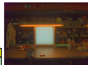
Abbildung 47: LuxBlick-Messung über jeweils 30 Minuten an den Arbeitsplätzen AP15 bis AP22 (TK-HB) mit einer Leuchtdichte von L = 1500 \text{ cd/m}^2 der Flächenleuchte während unterschiedlicher Beleuchtungssituationen
