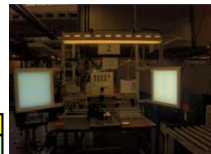
Abbildung 45: LuxBlick-Messung über jeweils 30 Minuten am Arbeitsplatz AP33 (FORD-A) mit einer Leuchtdichte von L = 1500 \text{ cd/m}^2 der Flächenleuchte während unterschiedlicher Beleuchtungssituationen
