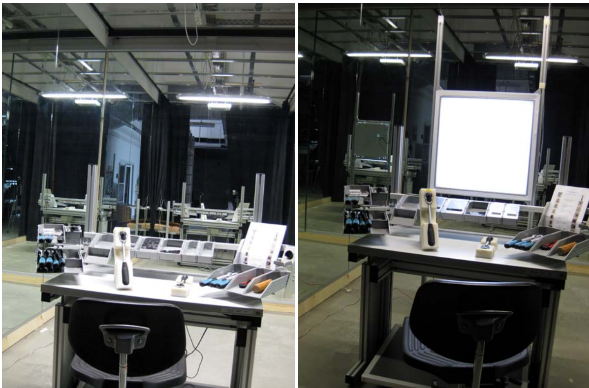
Abbildung 33: Laborarbeitsplatz links bei Allgemeinbeleuchtung (S1, S4), rechts bei Allgemeinbeleuchtung mit Flächenleuchte im Vorfeld (S2, S3)
