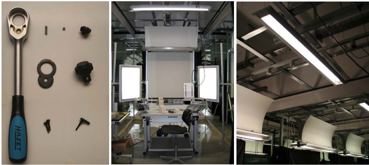
Abbildung 10: Teile für die Montage der Knarre (links), Blick auf den Laborarbeitsplatz für die Montage von Knarren mit Flächenleuchten im Vorfeld und seitlich (Mitte), Blick auf die Allgemeinbeleuchtung und Segelleuchten (rechts)
